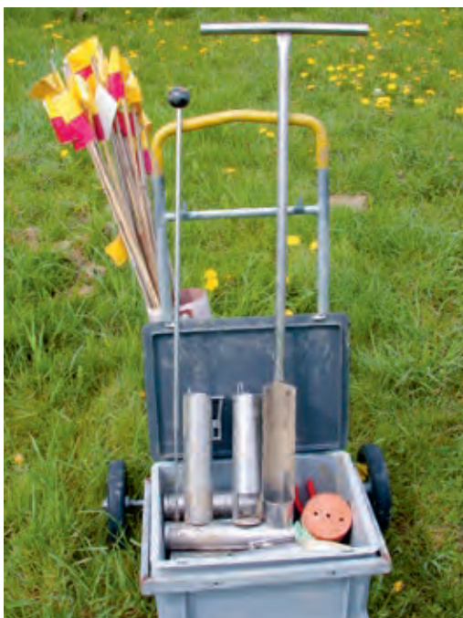
Le kit habituel du Topcat comprend une sonde, une tarière spécifique, des bâtonnets de marquage et une douzaine de pièges.
